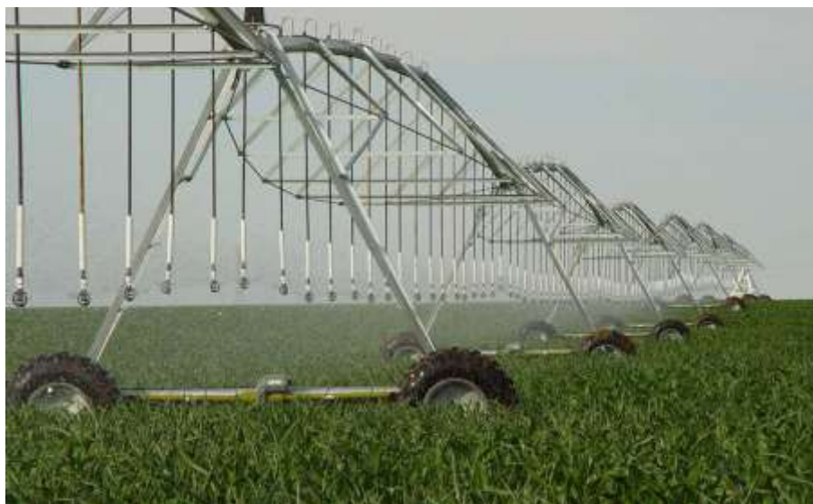
Impianto di irrigazione rainger (o pivot lineare)
